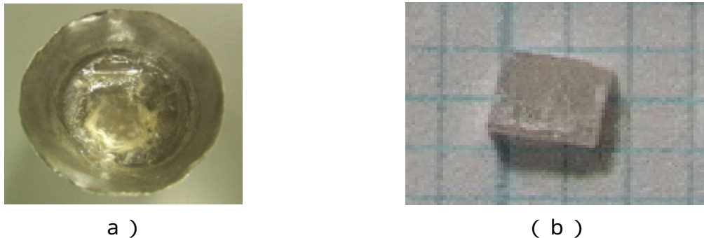
図1 熔融法で育成した \text{NaNbO}_3 結晶の白金つぼ内部(a)と \text{NaNbO}_3 単結晶(b)の写真 但し、結晶の大きさは 縦 = 1mm ~ 2mm, 横 = 1mm ~ 2mm, 厚さ(高さ) = 1 mm
